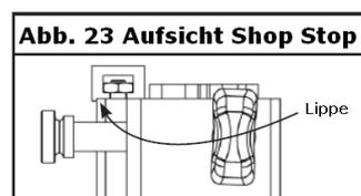
Stellen Sie den Anschlagarm so ein, dass dieser kurz über Ihrem Frästisch endet um Platz für Späne zu lassen. Ziehen Sie in dieser Position die Schraube wieder an. Sie können die Schraube umdrehen und den Anschlagarm auch auf der anderen Seite des Anschlagkörpers montieren, wenn Sie den Shop Stop an der Einlaufseite des Anschlags verwenden wollen.
