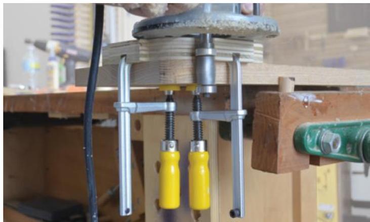
Das Befestigen von Vorrichtungen und Werkzeugen an der Hobelbank geht schnell und einfach. Fräsen Sie einfach ein paar Schwalbenschwanz-Nuten in ein Stück Multiplex und befestigen Sie das Werkzeug, das Sie auf der Hobelbank nutzen wollen daran. So können Sie die Werkzeuge in Sekunden wechseln.
