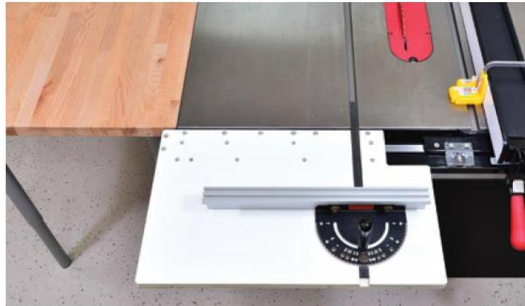
Montieren Sie innerhalb weniger Sekunden eine Erweiterung an Ihre Tragbare Kreissäge.
