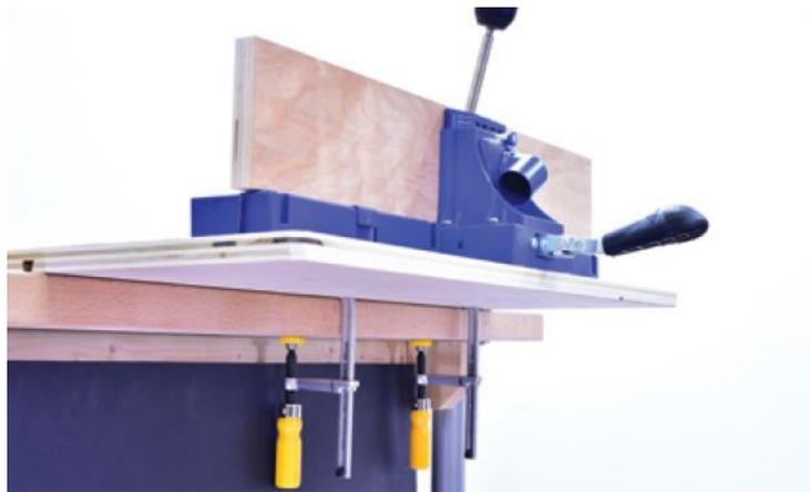
Nutzen Sie eine Führung für Ihre Handkreissäge um Bretter in Sekunden abzulängen. Die Schwalbenschwanz-Schraubzwingen sitzen in einer durchgehenden Nut unter der Führung, so dass Sie diese für Bretter beliebiger Breite nutzen können.
