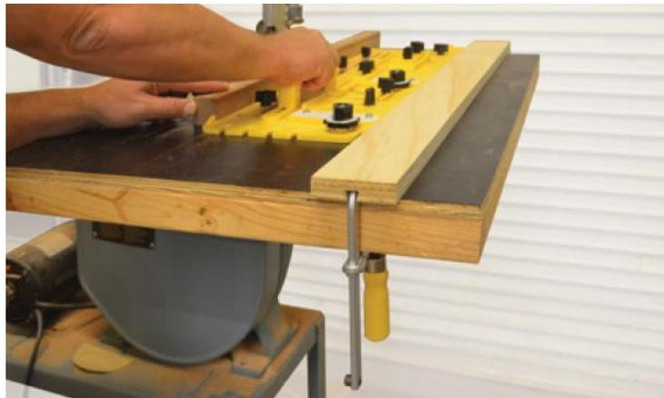
Befestigen Sie Spannvorrichtungen, wie diese an einem Frästisch, schnell und einfach. Die Schwalbenschwanz-Schraubzwingen ermöglichen es ohne dabei im Weg zu sein. Pläne finden Sie hier: [microjig.com/matchfitplans](http://microjig.com/matchfitplans)
