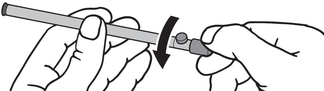
3. Schrauben Sie die Schraub ab und entfernen Sie das Schneidrad.
