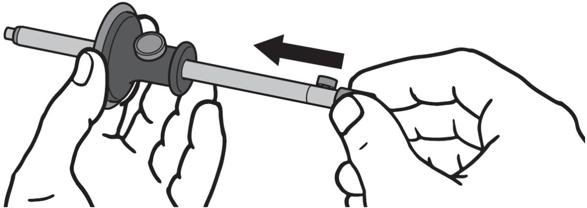
7. Betätigen Sie die Klemmschraube um den Körper des Streichmaßes auf dem neuen Stab zu fixieren.
