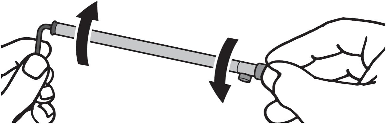
4. Drehen Sie die Feineinstellung komplett in die andere Richtung um die Spindel so weit wie möglich vorzuschieben.
