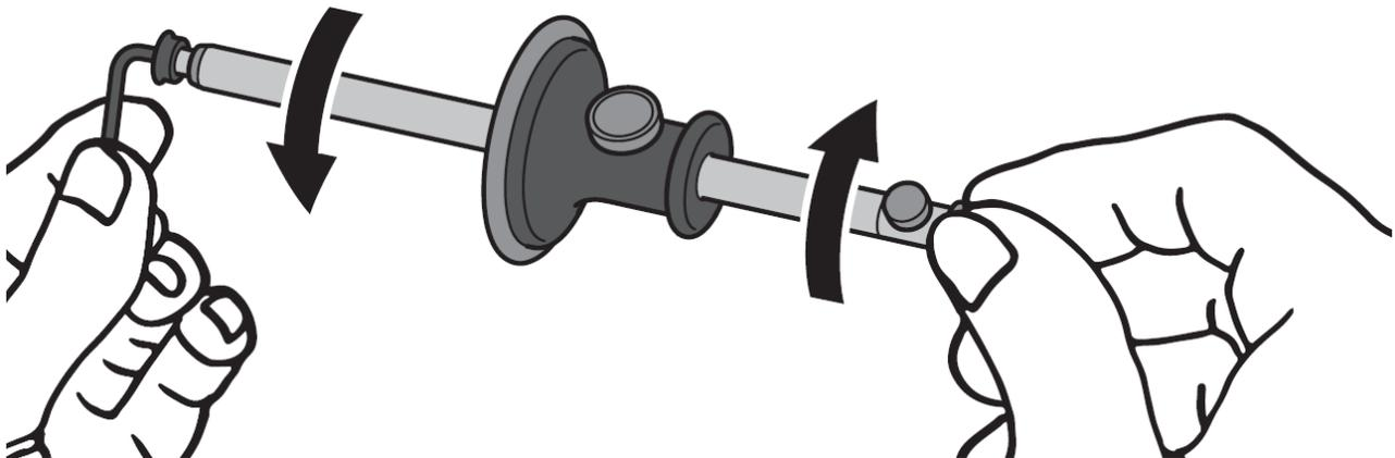
9. Lösen Sie die Feineinstellung, da deren Gewinde sich beim Anziehen der Schraube festgezogen hat.
