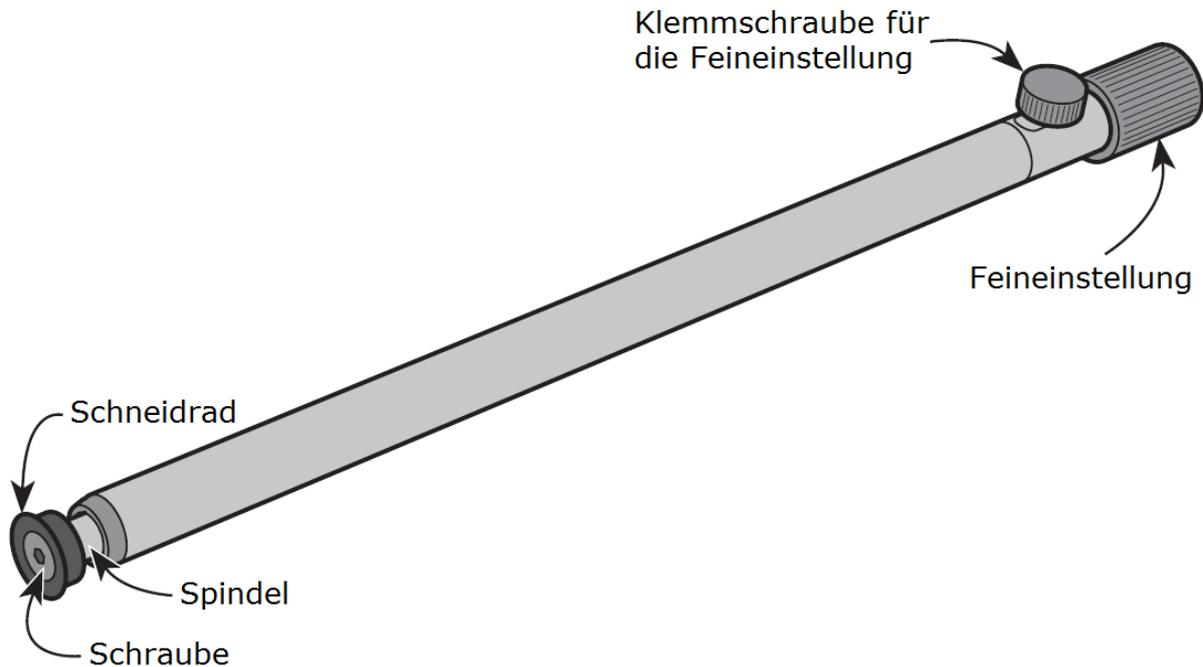
Zum Austausch des Stabes an Streichmaßen mit einer 7,94mm (5/16 inch) Bohrung im Körper:
