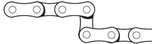
Wenn das geht, dann müssen Sie um ein halbes Glied zu entfernen zunächst ein ganzes entfernen (wie auf Seite 3 beschrieben) und dann das mitgelieferte halbe Glied einsetzen. Das Halbe Glied wird dabei in der gleichen Weise montiert wie das Verbindungsglied (und muss direkt neben diesem montiert werden). Um das halbe Glied zu verschließen stecken Sie zunächst den Bolzen durch die Laschen. Stecken Sie dann den Splint durch die Bohrung des Bolzens und biegen Sie die Enden um (siehe Abbildung).
