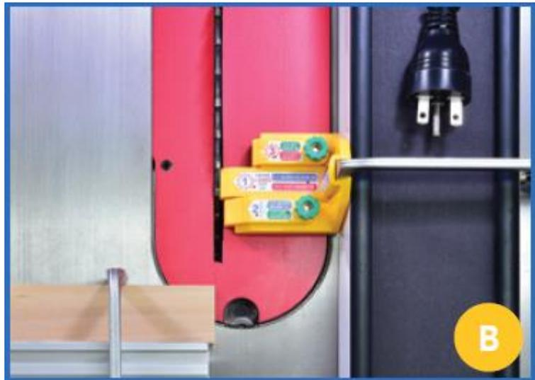
Schenkel 1 des Nutanschlags ist genau 76,2mm (3 inch) lang. Stellen Sie die Maßanzeige Ihres Längs-Anschlags auf 76,2mm ein. Ihr Anschlag ist jetzt perfekt auf das verwendete Sägeblatt eingestellt.
