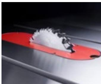
Mit Dado-Sägeblättern können Nut- und Falzschnitte, Falzen sowie Zapfenschnitte für Tischlerarbeiten, beispielsweise für Möbelrahmen oder Türen, ausgeführt werden.
