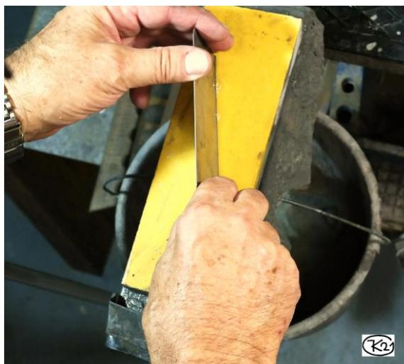
**Bild 16: Schleifen einer 90°- Standardziehklinge, freihändig**
