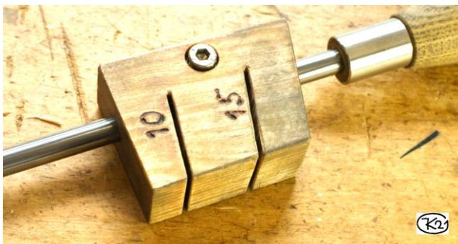
**Bild 27: Führung 10° / 15° mit Schlitzen**
