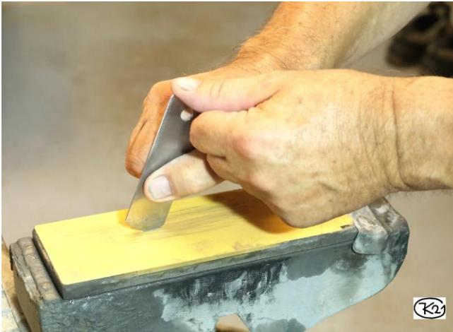
**Bild 22: Freihändiges Schleifen einer schmalen, nach außen gekrümmten Kantenfläche (Beispiel)**
