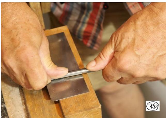
**Bild 19: Flachdrücken eines stumpfen Schneidrates** als erster Arbeitssgang um ihn aufzufrischen (Klinge liegt auf Hartholzklötz).
