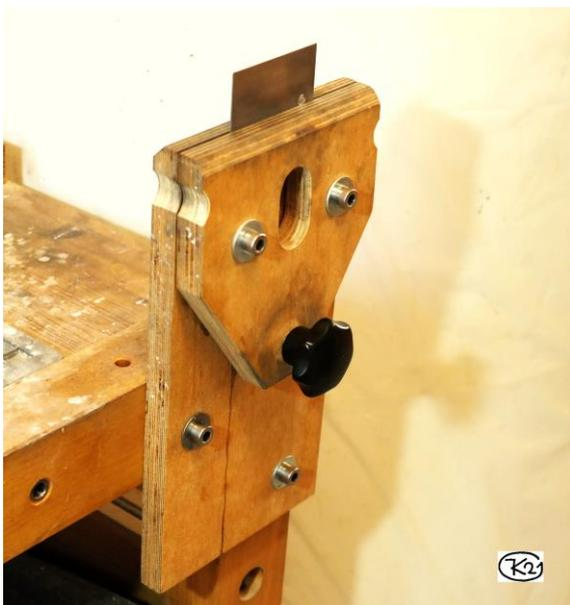
**Bild 31: Spannstock für Ziehklingen**
