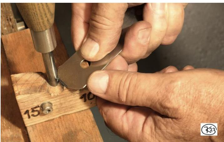
**Bild 23: Andrücken des Schneidgrates an eine kleine Zieh Klinge mit nach außen gekrümmter Schneide.**
