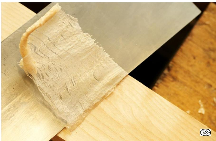
**Bild 21: Span einer aufwändiger geschärften 90°-Ziehklinge**
