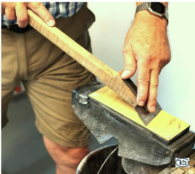
**Bild 24: Freihändiges Schleifen einer 45°- Ziehklinge mit einem Halter**
