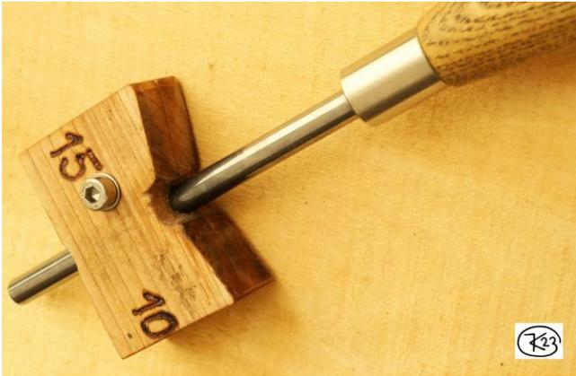
**Bild 28: Noch eine Führung** (10° und 15°, z.B. für kleine Sonderziehklingen)
