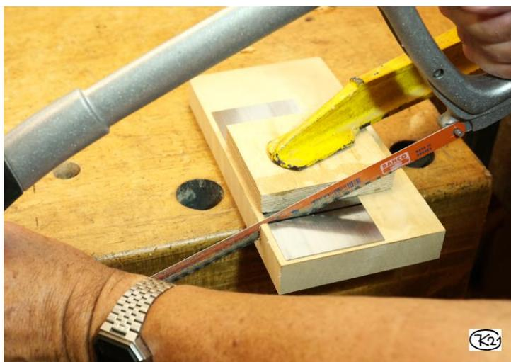
**Bild 25: Sagen von Federstahlblech (hier: Auftrennen einer Ziehklinge)**
