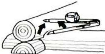
Anriss der Hohlkehle an der Unterseite des Blockholzes
