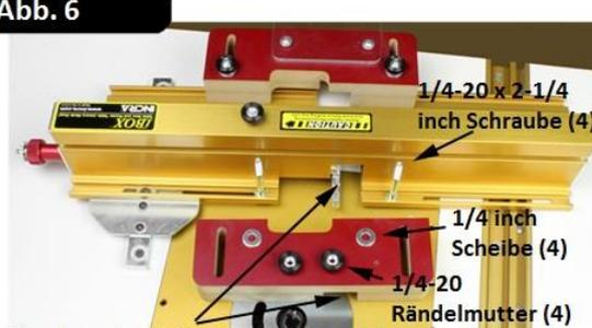
Der Ausschnitt für den Fräser und der Ausschnitt an der Abdeckung fluchten (Rückseite des Anschlags).
