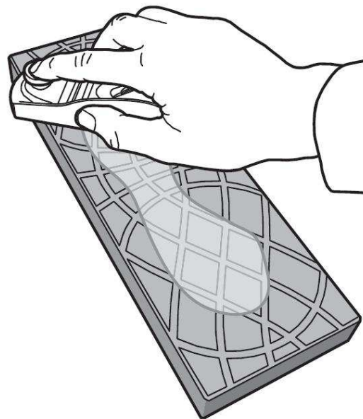
Abbildung 3: Vorbereitung der Lappplatte
